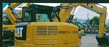
CAT油圧ショベル 308E2CR 2015年 1845HRS CAB・配管・クレーン
