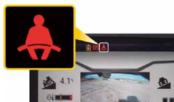
シートベルト未装着時にモニタ画面にアイコンが表示されます
