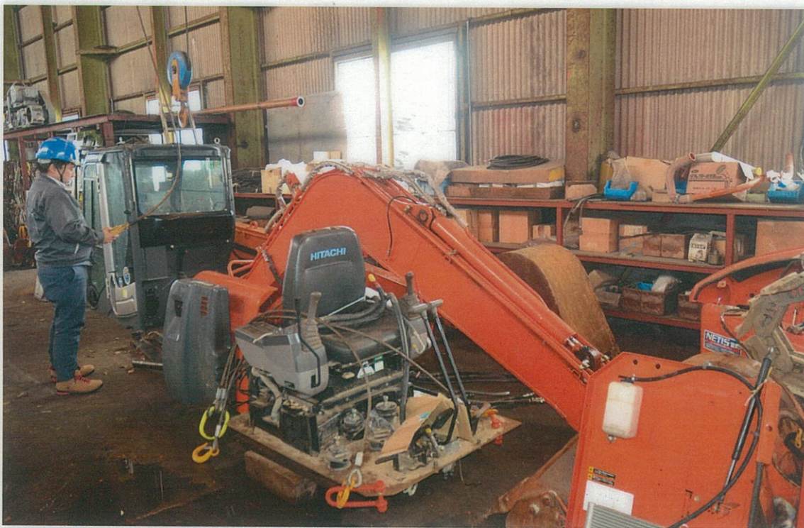
短時間で分解・組み立てできるように改造した油圧ショベル＝富山市田中町
